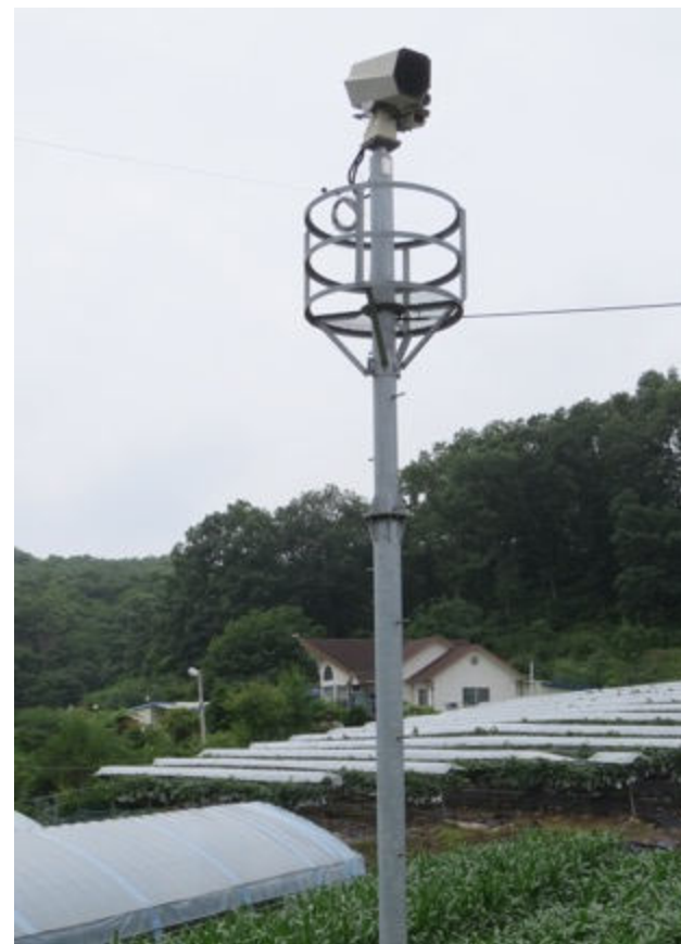
有害鳥類音波退治システム DIXXEN S2R
