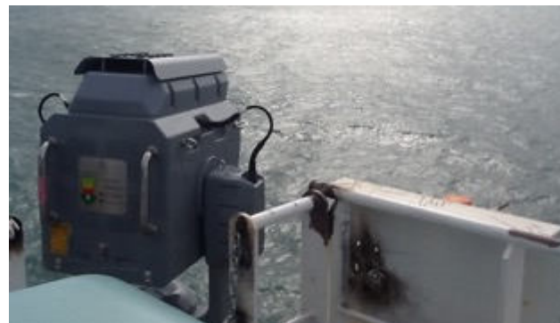
KOTC (Kuwait Oil Tanker Company)原油運搬船 海賊防御システム(Anti Piracy System) DIXXEN S4R
